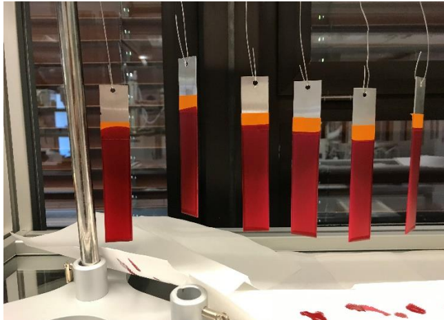
Abbildung 2: Beschichtete Aluminium-Plättchen (Prüfkörper)
